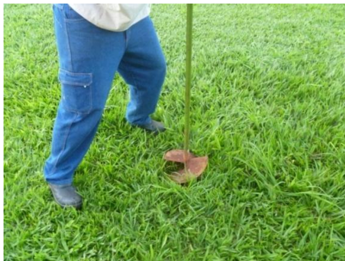
Figura 4. Equipamento para abertura da camada vegetal
