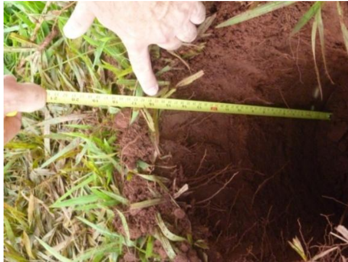
Figura 6. Medição da profundidade da escavação.
